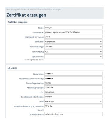
Achten Sie darauf, für den "Common Name (CN)" **immer** einen einmaligen Namen zu wählen. Das Anlegen eines weiteren Zertifikats mit dem identischen CN ist nicht erlaubt.
